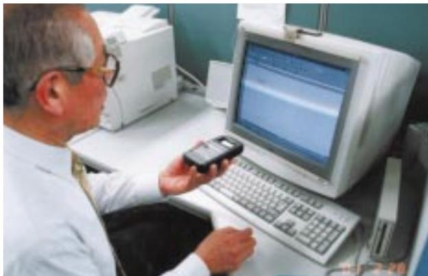
写真2 VDT磁場の測定の例
